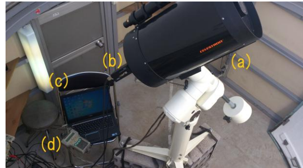
図3：望遠鏡制御システム。(a)望遠鏡(C11、口径280mm)、(b)3CCDカラービデオカメラ(XC-003)、(c)PC(追尾補正ソフトを含む)、(d)スカイセンサーで構成される。
