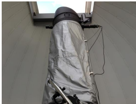
図 3. メタンバンドフィルターを用いた観測に使用している望遠鏡 (NGT-18)。右上に見えるのが Power Mate( \times 4 )と WAT-100N(CCD ビデオカメラ) である。
