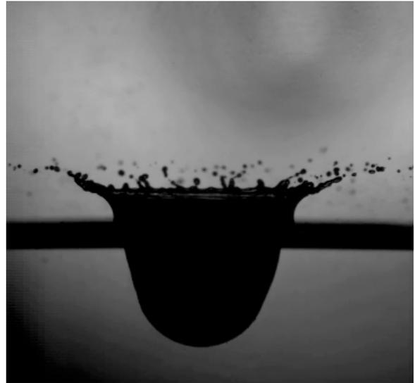
図 1 : 鉄球-水衝突によるクラウン形成
