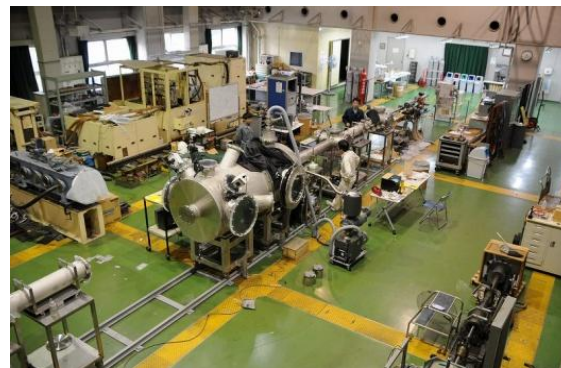
図1. JAXA宇宙科学研究本部の二段式軽ガス銃。
