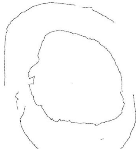
図. 2 垂直衝突により形成されたクレーターの inner spall、outer spall の輪郭をトレースし、2.5 度ごとに分割したもの。
